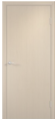
Siseuksed: Sile spoonitud siseuks, vertikaalne tammespoon, toonitud valge lakiga. Puitleng, uksega samas toonis tihendid lengis. Ilma lävepakuta või madal, ventileeritav lävepakk. Piirdeliistud uksega kompleksis, uksega samas toonis, kandilised, spoonitud 58mm. Tarnija: Ehituse ABC
