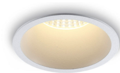
Süvistatud valgustid: Aston Interior art: AST-0253, valge, LED 9W, 3000K, 800lm, diam. 105mm, IP40 Tarnija: Aston Interior/ Ehituse ABC
